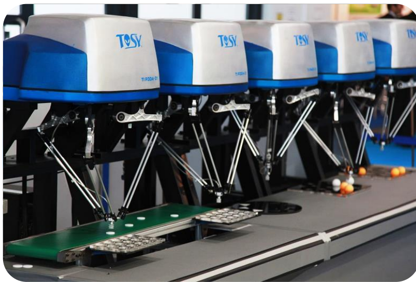
ภาพที่ 1-1 หุ่นยนต์เดลต้า 3 แขน (ที่มา : http://en.wikipedia.org/wiki/Delta_robot )
