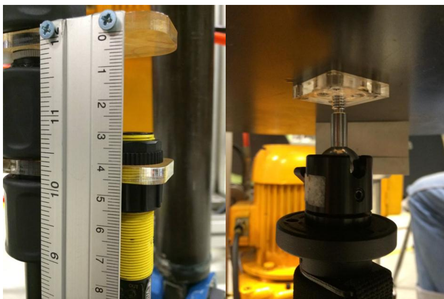
ภาพที่ 3-13 การติดตั้งเซ็นเซอร์วัดระยะทางแบบอัลตราโซนิกและหัวข้อต่ออิสระ
