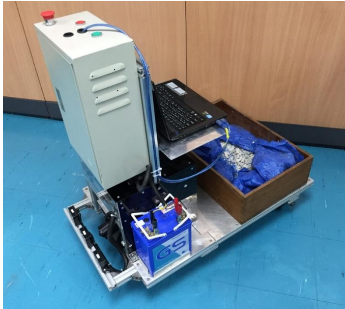
ภาพที่ 3-35 การบรรทุกภาระไหลدنน้ำหนัก 25 กิโลกรัม
