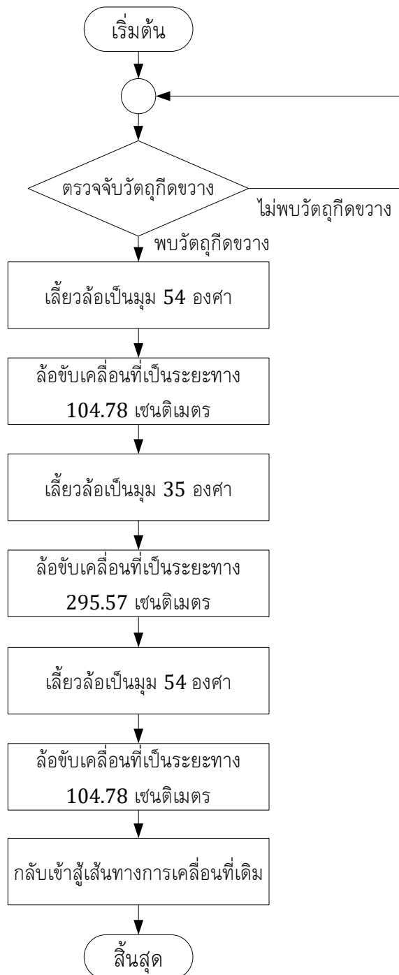
ภาพที่ 3-3 แผนภาพขั้นตอนการหลบหลีกสิ่งกีดขวาง ที่อยู่ในเส้นทางการเคลื่อนที่แบบทางตรง ของหุ่นยนต์เคลื่อนที่ด้วยล้อ แบบ 3 ล้อ
