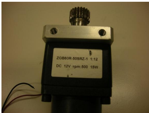
ภาพที่ 3-8 มอเตอร์กระแสตรงที่ใช้
