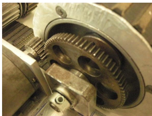
ภาพที่ 3-7(ข) ชุดเฟืองเกียร์ที่ติดตั้งใหม่
