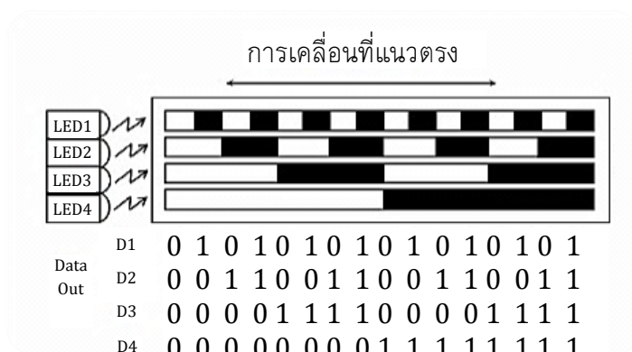
ภาพที่ 2-11 เอ็นโค้ดเดอร์แบบลัมบวร์คแบบเลื่อนแนวตรงขนาด 4 บิต
