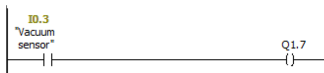
ภาพที่ จ-12 โปรแกรมการทำงานของ Distribution Station Step ที่ 12
