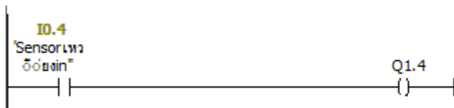
ภาพที่ จ-13 โปรแกรมการทำงานของ Distribution Station Step ที่ 13
