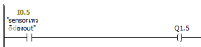
ภาพที่ จ-14 โปรแกรมการทำงานของ Distribution Station Step ที่ 14
