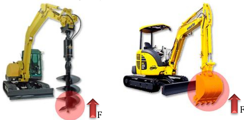
ภาพที่ 1-1 รถขุดเจาะก็เป็นรถที่ทำงานด้วยระบบไฮดรอลิกส์
