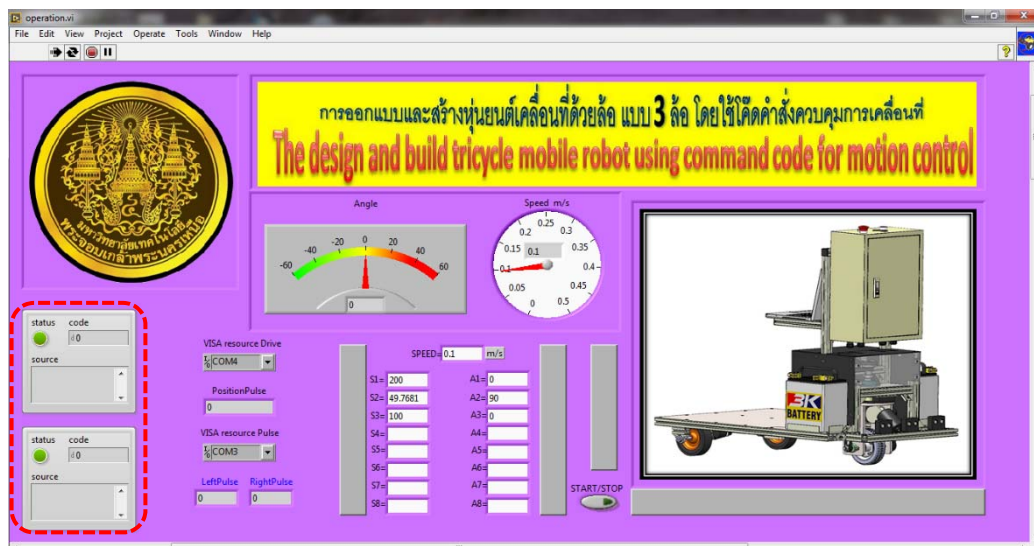
ภาพที่ ก-22 ไฟแสดงสถานะ การเชื่อมต่อระหว่างหน้าต่างโปรแกรม GUI กับบอร์ด Motion control SDC2130 และบอร์ดไมโครคอนโทรลเลอร์ STM32F4 Discovery
