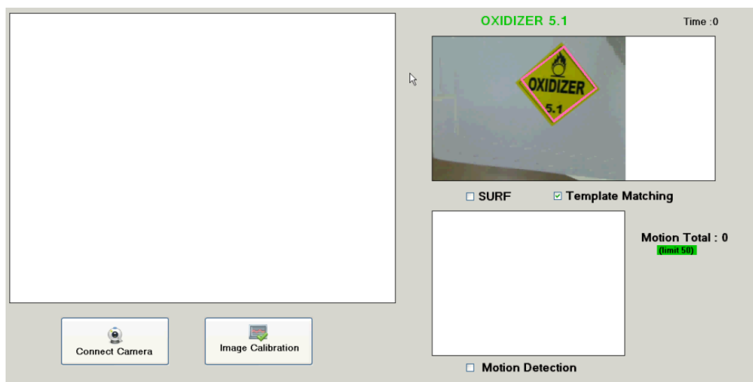
ภาพที่ ค-11 การอินเตอร์เฟสการเปรียบเทียบภาพด้วยวิธี Template Matching
