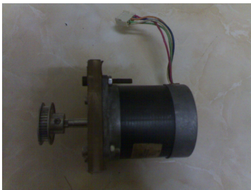
ภาพที่ 3.6 สเต็ปปีงมอเตอร์ ที่เลือกใช้ขับเคลื่อนบอลสกรู
