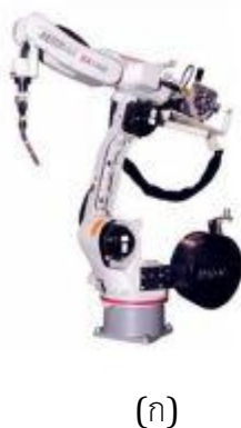
ภาพที่ 2-24 (ก) ลักษณะหุ่นยนต์แบบข้อต่อ (ข) พื้นที่การทำงานของหุ่นยนต์แบบข้อต่อ
