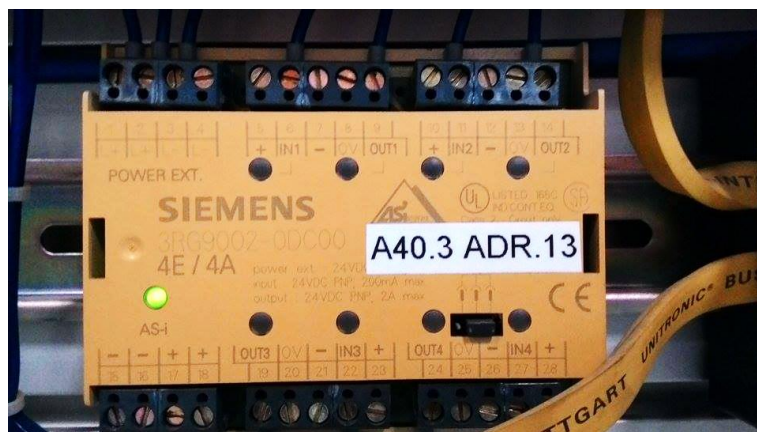
ภาพที่ 2-15 ระบบ AS-i ของจริง ของชุดทดลองพีแอลซี รุ่น FMS 50
