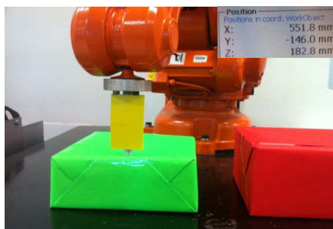
ภาพที่ 4-11 ตำแหน่งหุ่นยนต์ก่อนการกดวัตถุที่มีค่าความแข็งต่ำตำแหน่งที่หนึ่ง
