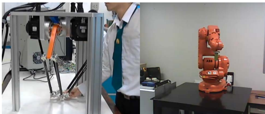
ภาพที่ 4-1 การควบคุมระยะไกลโดยใช้หุ่นยนต์อุตสาหกรรม 3 แกนแบบเดลต้าแบบไม่มีการกวดำตร
