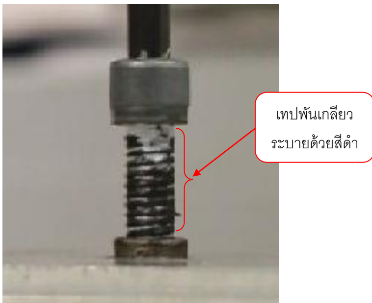
ภาพที่ 4-1 ลักษณะจำลองการวัดแรงบิด
