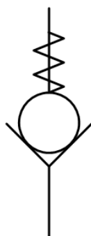
ภาพที่ 2.8 สัญลักษณ์อุปกรณ์ควบคุมการไหล
