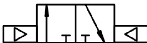
ภาพที่ 2.27 ตัวอย่างสัญลักษณ์วาล์วเปลี่ยนทิศทางการไหล
