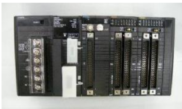
ภาพที่ 2.32 แสดงโปรแกรมเมเบิลลอจิกคอนโทรลเลอร์ (Programmable Logic Controller: PLC)
