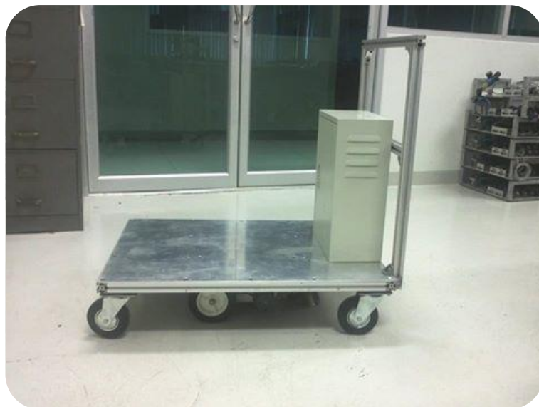
ภาพที่ 3 - 23 ประกอบรถขับ รถเข็นและตู้คอนโทรลเรียบร้อยแล้ว
