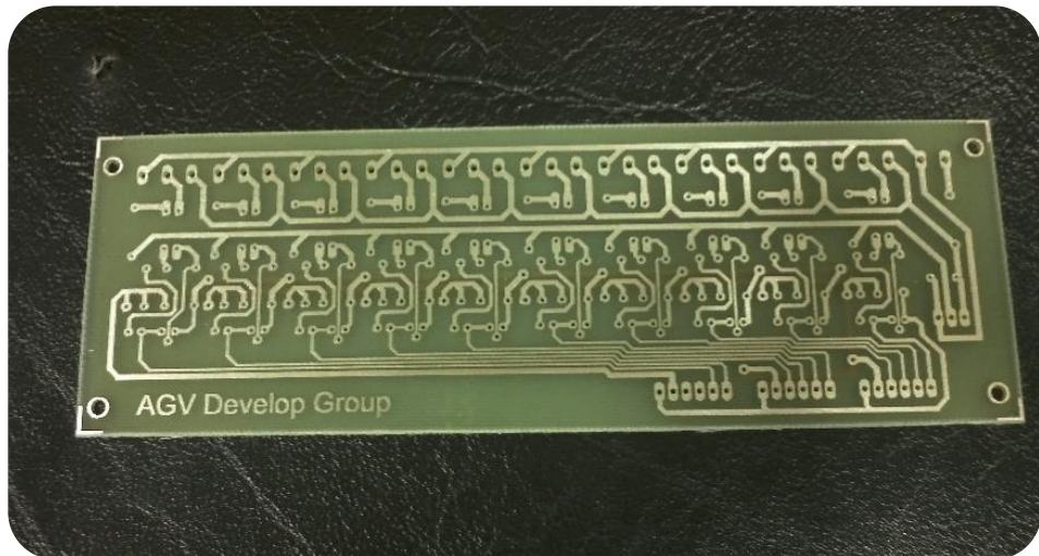
ภาพที่ 3 - 20 แผนลายทองแดงของวงจรแยกสัญญาณอินพุต
