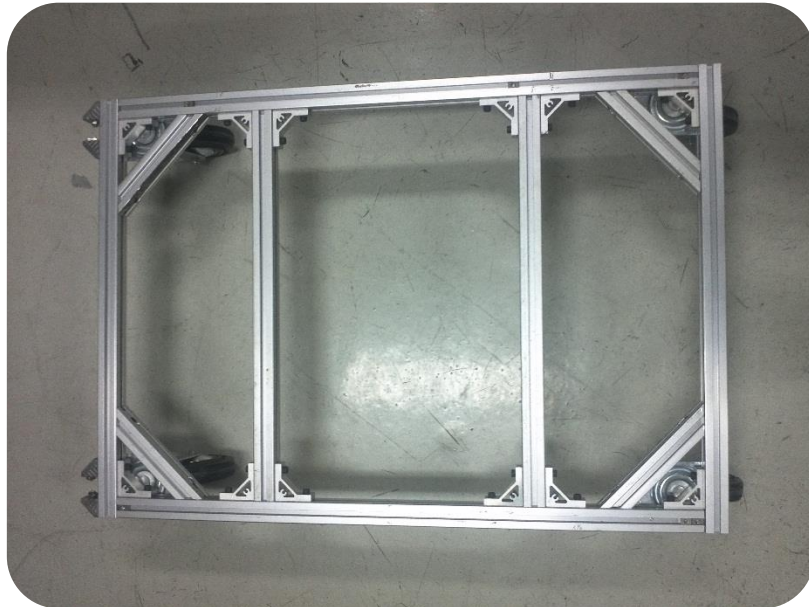
ภาพที่ 3 - 18 จัดทำโครงสร้างรถเข็น
