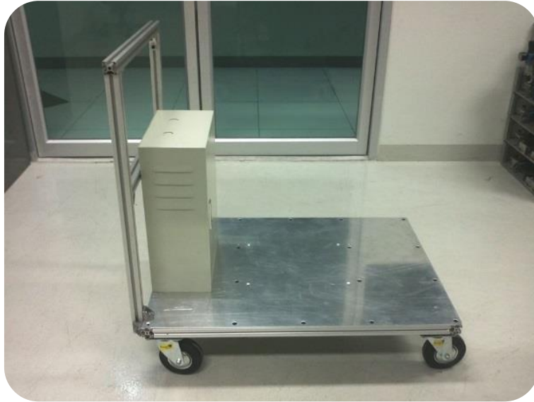
ภาพที่ 3 - 22 ประกอบตู้คอนโทรลกับตัวโครงสร้างรถ
