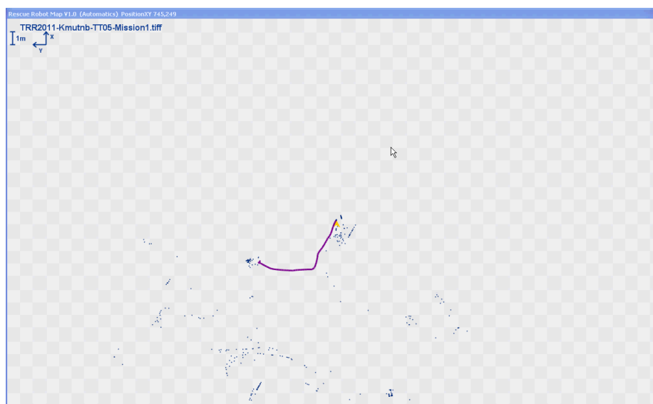
ภาพที่ 4-40 ผลการทดลองการวาดแผนที่ขณะวิ่งอัตโนมัติ
