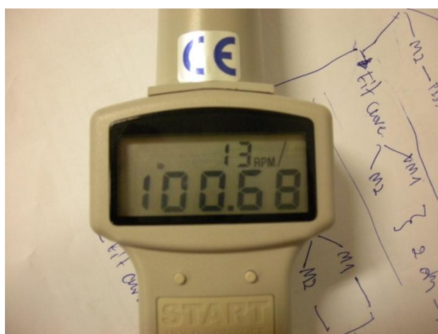
ภาพที่ 4-12 การควบคุมมอเตอร์ด้านขวาที่ได้จากเครื่องมือวัด
