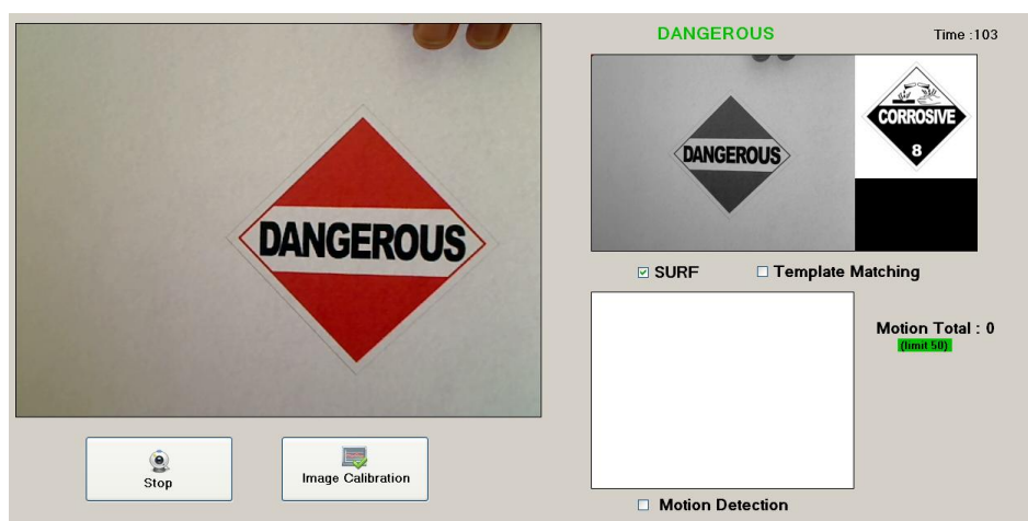
ภาพที่ 4-48 ผลการทดลองการตรวจจับภาพด้วยวิธี SURF
