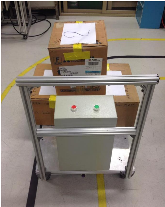
ภาพที่ 4-8 ภาระโหลด 60 กิโลกรัม ที่ใช้ในการทดสอบการรับภาระโหลดของรถเอจีวี
