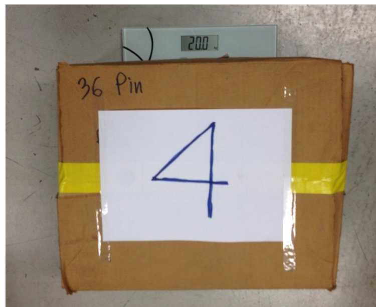
ภาพที่ 4-5 ภาระโหลด กล่องที่ 4 น้ำหนัก 20 กิโลกรัม ที่ใช้ในการทดสอบการรับภาระโหลดของรถเอจีวี
