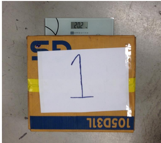
ภาพที่ 4-2 ภาระโหลด กล่องที่ 1 น้ำหนัก 20 กิโลกรัม ที่ใช้ในการทดสอบการรับภาระโหลด ของรถเอจีวี
