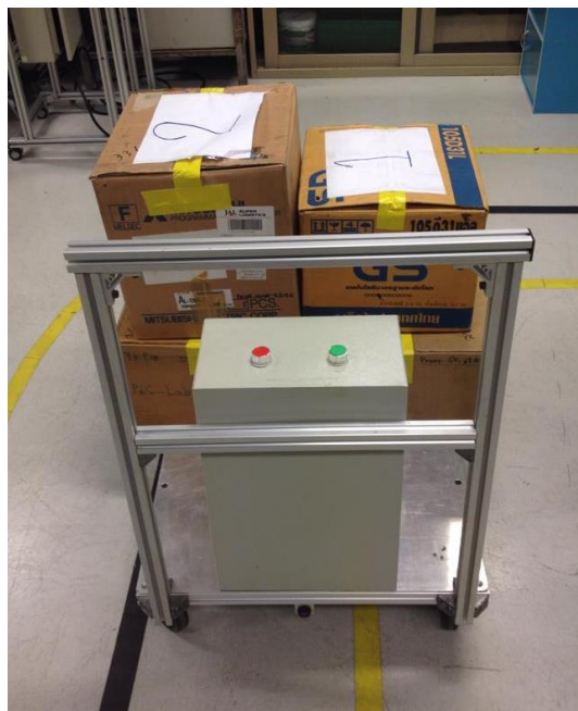
ภาพที่ 4-9 ภาระโหลด 80 กิโลกรัม ที่ใช้ในการทดสอบการรับภาระโหลดของรถเอจีวี
