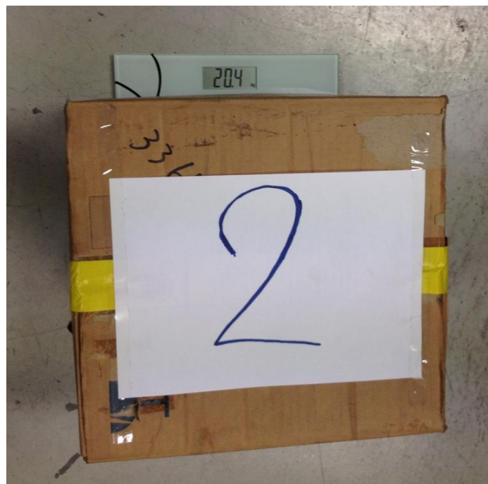
ภาพที่ 4-3 ภาระโหลด กล่องที่ 2 น้ำหนัก 20 กิโลกรัม ที่ใช้ในการทดสอบการรับภาระโหลด ของรถเอจีวี
