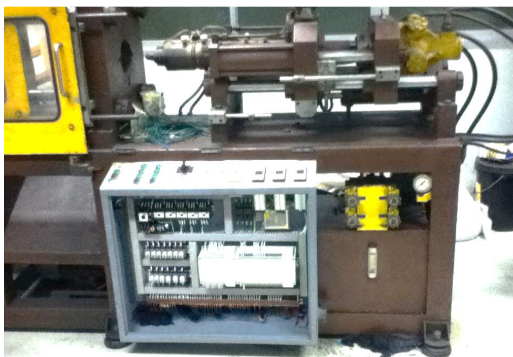
ภาพที่ ข-8 เดินสายไฟที่เครื่องฉีดพลาสติก
