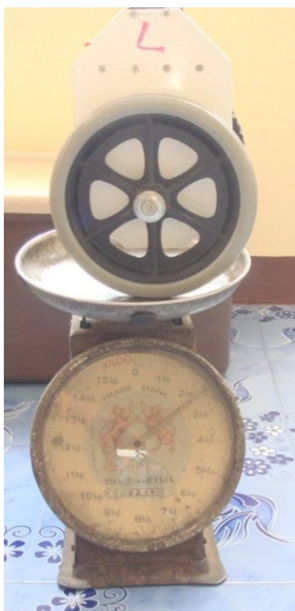
ภาพที่ 3.10 น้ำหนักทางด้านซ้ายของระบบขับเคลื่อนล้อเดียวรักษาสสมดุลแนวตรง
