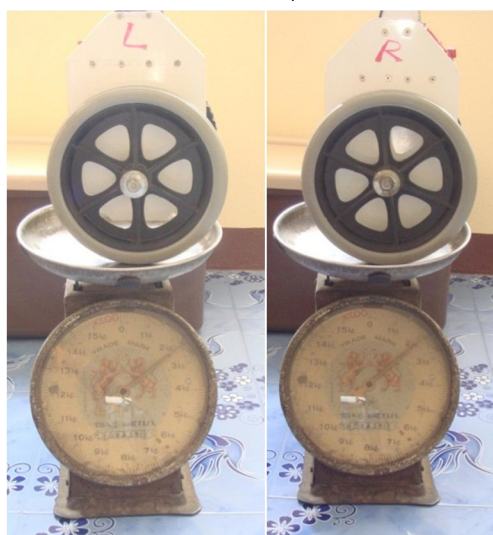
ภาพที่ 3.16 น้ำหนักด้านข้างของระบบขับเคลื่อนล้อเดียวรักษาสมดุลแนวตรง
