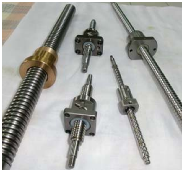
ภาพที่ 2.21 แสดงลักษณะของบอลสกรูแบบต่างๆ ที่นิยมใช้กันโดยทั่วไป
