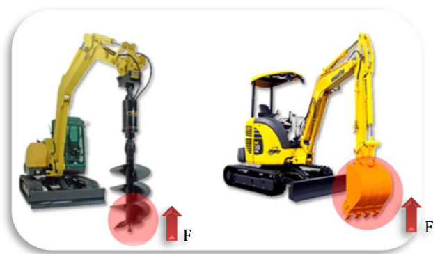
ภาพที่ 1 รถขุดเจาะก็เป็นรถที่ทำงานด้วยระบบไฮดรอลิกส์
