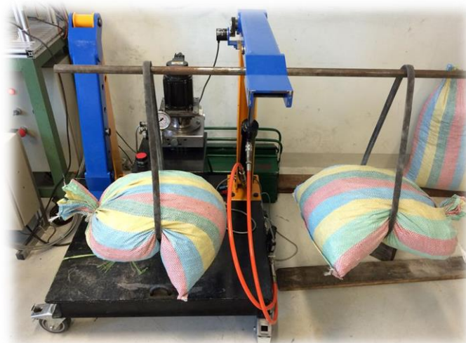
ภาพที่ 4-10 การทดลองแบบแรงที่ป้อนกลับมายังชุด Master เกิดจากความดันภายในกระบอกลูกสูบไฮดรอลิกส์
