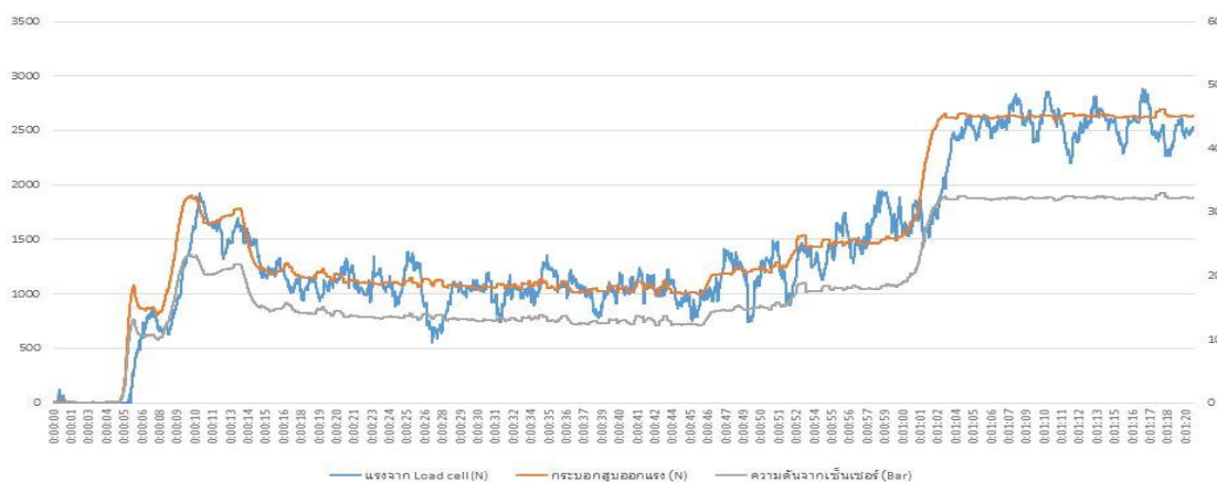
ภาพที่ 4-33 กราฟแสดงแรงที่ป้อนกลับมากับน้ำหนักของโหลดและความดันที่เกิดขึ้น
