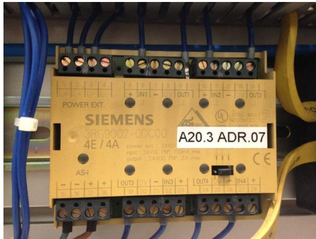
ภาพที่ 2-14 ระบบ AS-I ของจริง ของชุดทดลองพีแอลซี รุ่น FMS 50
