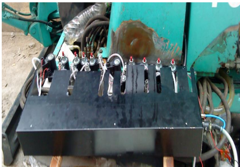
ภาพที่ 4.4 การติดตั้งตัวครอบวาล์วเข้ากับตัวรถไฮดรอลิก
