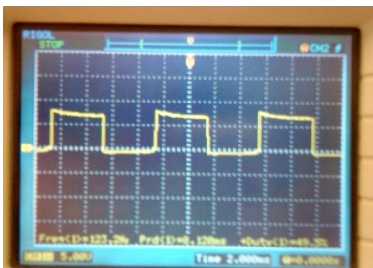
ภาพที่ 4.8 สัญญาณPWM ที่ได้จากไมโครคอนโทรลเลอร์
