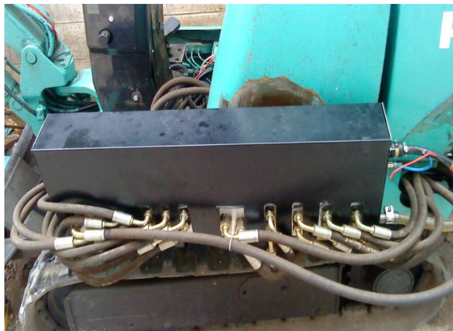
ภาพที่ 4.4 การติดตั้งตัวครอบวาล์วเข้ากับตัวรถไฮดรอลิก (ต่อ)
