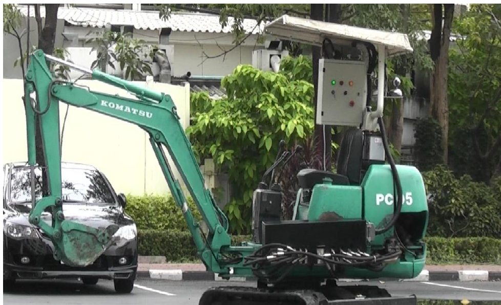
ภาพที่ 4.17 เป็นการทดสอบระบบการควบคุมระยะไกลไฮดรอลิกแบบไร้สาย
