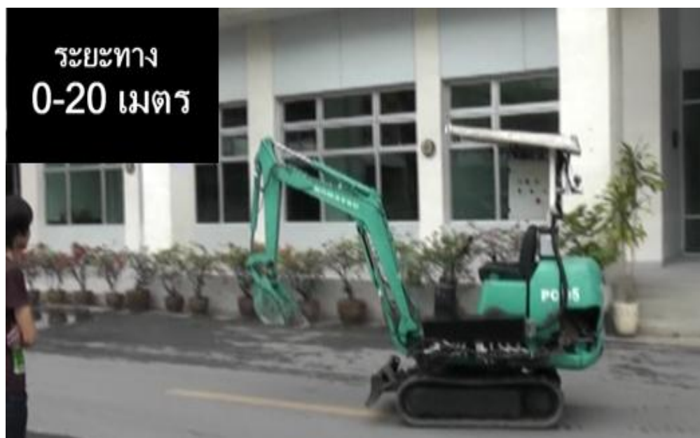
ภาพที่ 4.18 เป็นการทดสอบระบบการควบคุมรถขุดไฮดรอลิกแบบไร้สายระยะที่ 0-20 เมตร
