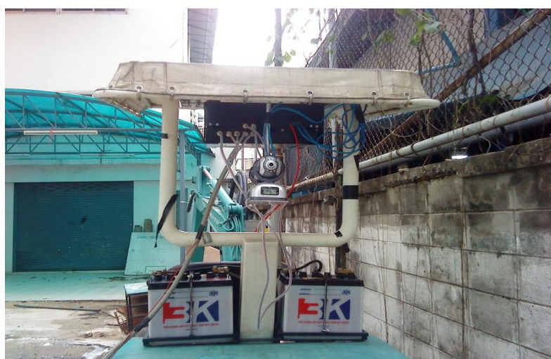
ภาพที่ 4.6 การติดตั้งแบตเตอรี่และกล้อง IP Camera เข้ากับตัวรถ
