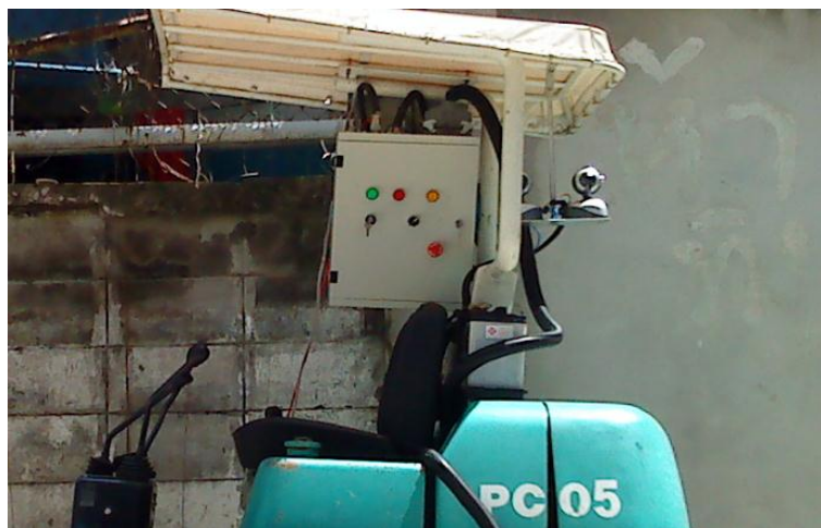
ภาพที่ 4.5 การติดตั้งตู้ควบคุมเข้ากับตัวรถ
