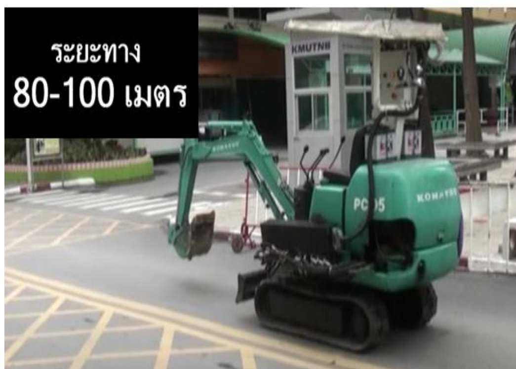
ภาพที่ 4.21 เป็นการทดสอบระบบการควบคุมรถขุดไฮดรอลิกแบบไร้สายระยะที่ 80-100 เมตร
