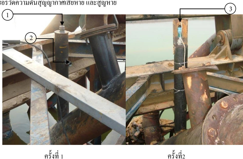
ภาพที่ 4.16 ภาพการติดตั้งท่อวัดความดันสุญญากาศครั้งที่ 1 และ 2 (1) ที่สำหรับติดตั้งเซ็นเซอร์วัดความดันสุญญากาศ (2) รูสำหรับติดตั้งเซ็นเซอร์วัดความดันสุญญากาศ (3) ติดตั้งเซ็นเซอร์วัดความดันสุญญากาศ
