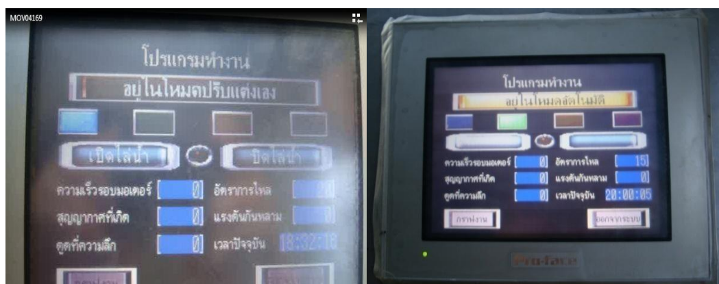
ภาพที่ 4.20 ลักษณะของหน้าจอแบบสั่งงานด้วยมือ และแบบทำงานอัตโนมัติ
