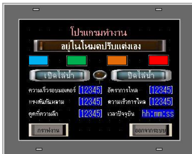
ภาพที่ 4.21 แสดงหน้าจอแสดงการทำงาน และสีแสดงสถานะของอัตราการไหล
