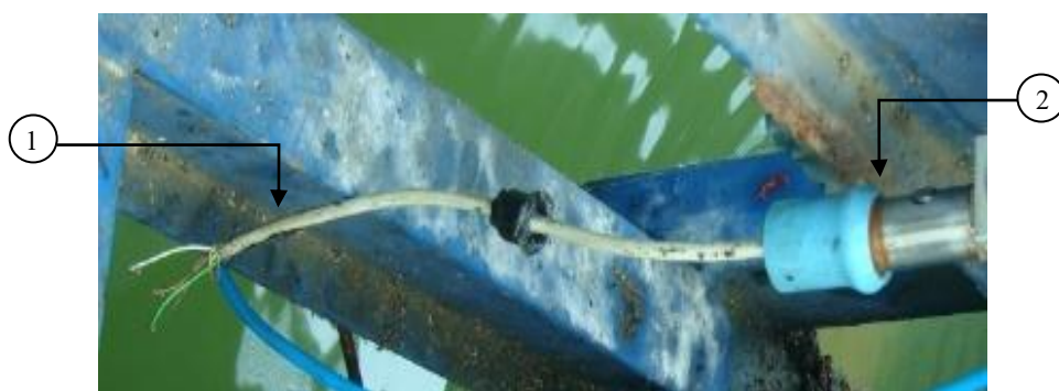
ภาพที่ 4.18 ลักษณะของเซ็นเซอร์วัดความดันสุญญากาศที่สายสัญญาณขาด (1) เซ็นเซอร์วัดความดันสุญญากาศ (2) สายสัญญาณของเซ็นเซอร์วัดความดันสุญญากาศ
