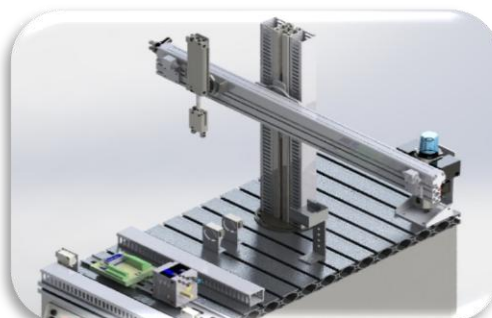
ภาพที่ 5 ภาพกราฟฟิกสถานีขนถ่ายชิ้นงาน โดยโปรแกรมช่วยในการออกแบบ
