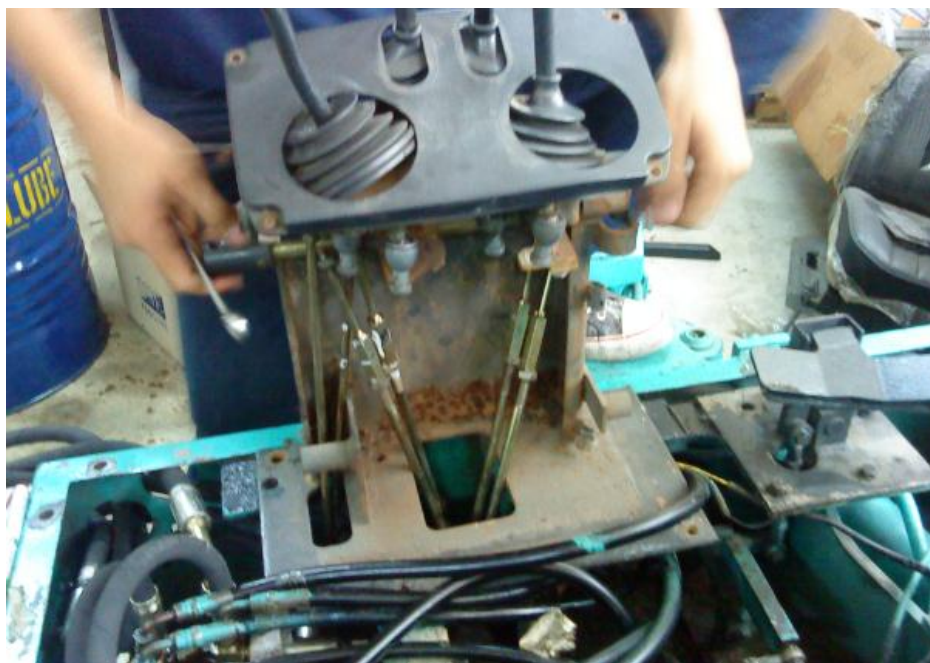
ภาพที่ 3.34 การติดตั้งอุปกรณ์เดิมเข้าไปในตัวรถ
