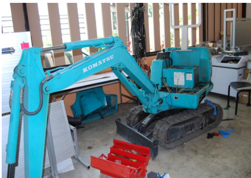
ภาพที่ 3.24 การถอดชิ้นส่วนต่างๆของรถขุดไฮดรอลิก
