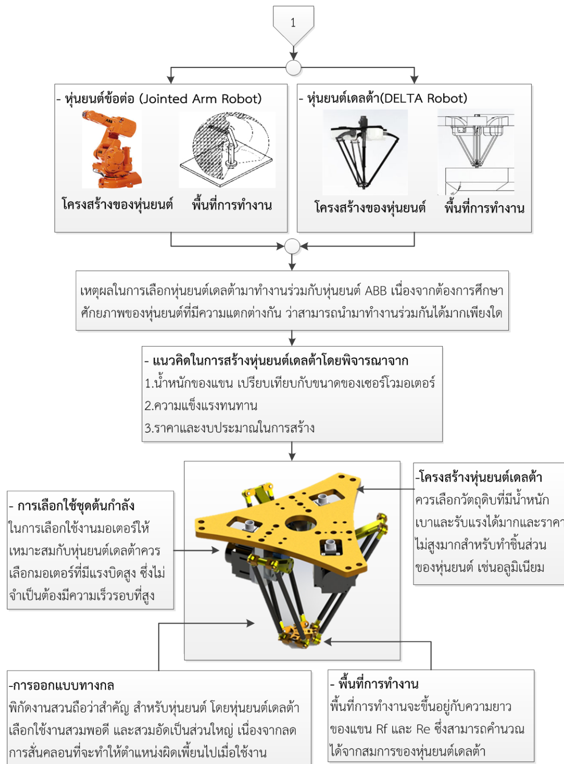
ภาพที่ 3-3 แผนผังแนวคิดในการสร้างโครงงานการควบคุมระยะไกลด้วยหุ่นยนต์อุตสาหกรรม
