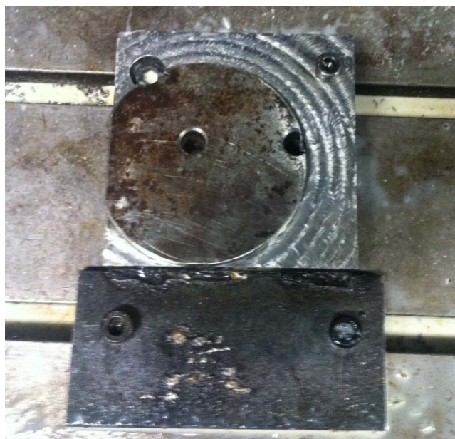
ภาพที่ 3-30 เริ่มทำจิ๊ก (Jig) อย่างง่ายเพื่อผลิตชิ้นงานด้วยซีเอ็นซี
