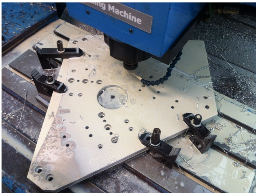
ภาพที่ 3-31 เจาะรูบนชิ้นงานด้วยซีเอ็นซีด้วยจีโค้ดที่ได้จากโปรแกรม SolidCAM 2012
