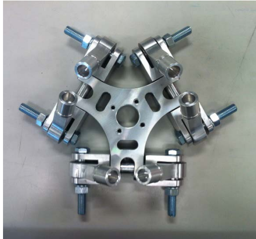
ภาพที่ 3-33 การประกอบชิ้นส่วนของหุ่นยนต์ที่ผ่านกระบวนการซีเอ็นซี
