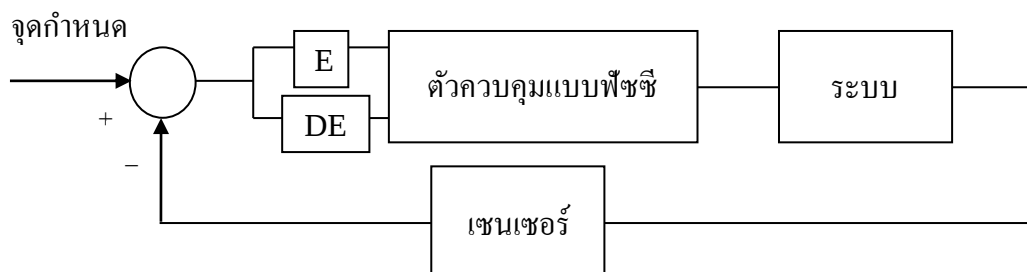
รูปที่ 2.30 แผนภาพบล็อกการควบคุมระดับน้ำโดยใช้ตัวควบคุมแบบฟัซซี
